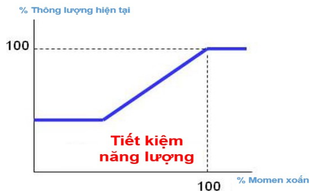
Hình 3.46: Quan hệ giữa dòng từ thông và mômen của động cơ khi có biến tần
