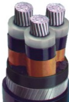
Hình 3.34: Cáp ngầm trung thế nhôm CADIVI AXV/SE-SWA 24kV
