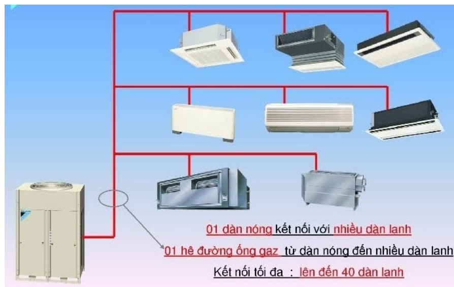
Hình 3.23: Hệ thống điều hòa VRV
