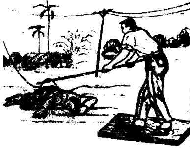
Hình 9.3. Dùng sào hay cây gạt dây điện ra khỏi nạn nhân
