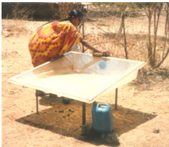
Hình 4.92. Thiết bị chưng cất 5kg/ngày.
