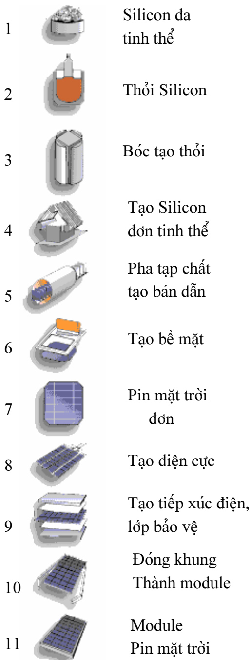
Hình 3.6. Quá trình tạo module
