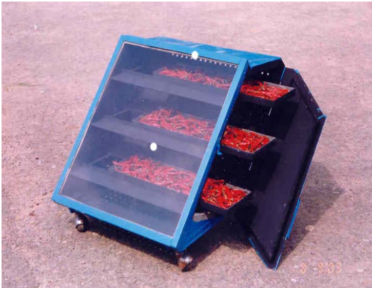
Hình 4.73. Tủ sấy trái cây dùng năng lượng mặt trời.
