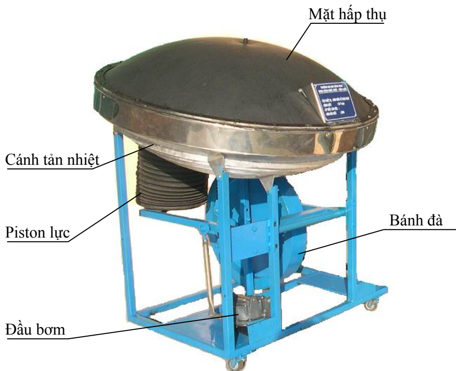
Hình 4.103. Bơm nước dùng năng lượng mặt trời công suất 5m^3/ngày
